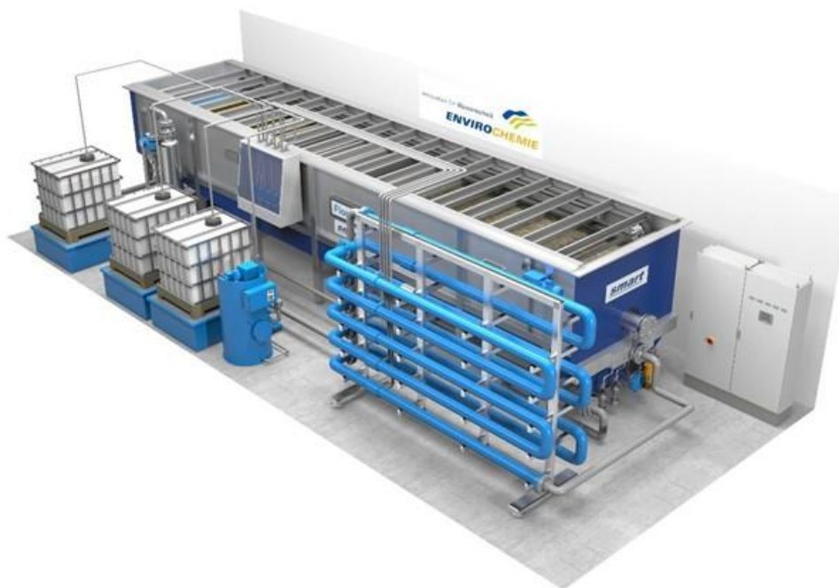
Slika 25. Trodimenzionalni prikaz (3D model) kompletne kompaktne flotacione jedinice sa dozirnim rezervoarima i cevnim flokulatorom
