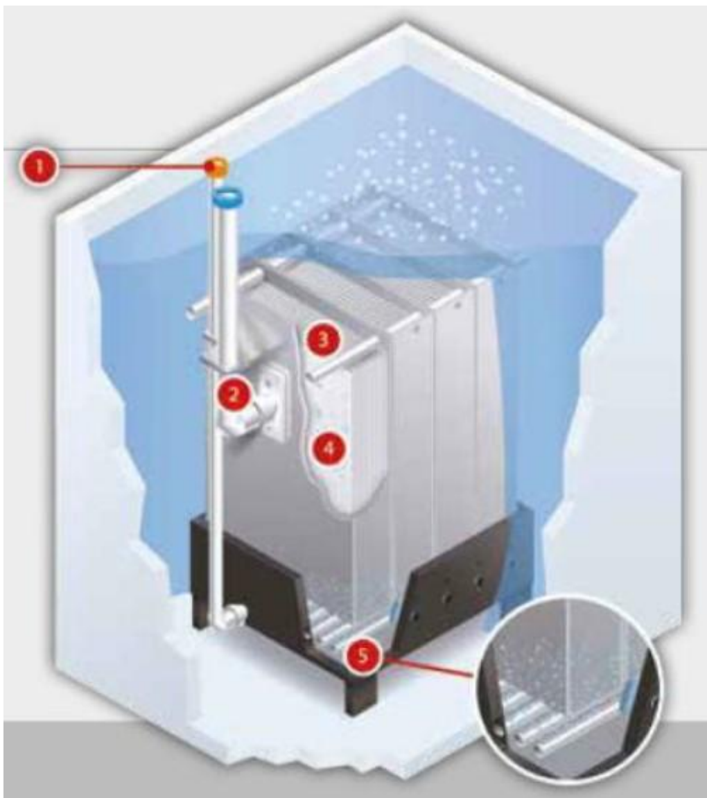
Slika 30. Konstruktivna šema potopljenog membranskog modula u aerobnom bazenu
